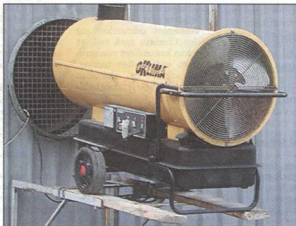
Oklima SE280 varmekanon er en af de varmekanoner, der har en høj virkningsgrad og er derfor velegnet til korn-tørring.
